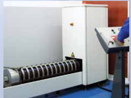
Hızlı Çatlak Yayılması Testi
